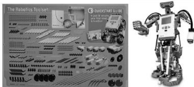
Figura 2: Kit LEGO Mindstorms® com NXT e um exemplo de montagem. Fonte: http://mindstorms.lego.com
